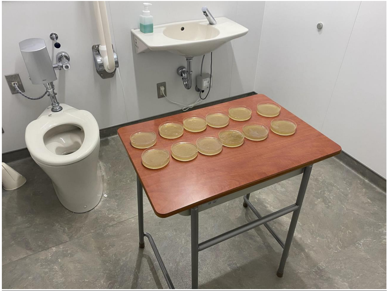
写真1：トイレの個室での落下菌の採集
